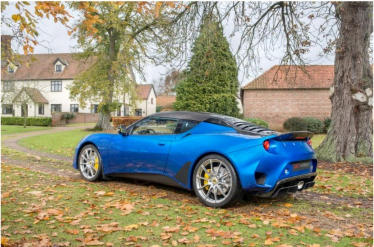
エヴォーラ GT410 スポーツの開発において、ロータスは重量の最適化を図り、その結果、車両重量 1,297kg（オプションのチタン製エキゾーストによる 10kg 削減、ロータス専用、オーリンズ TTX アルミ 2ウェイ・アジャスタブル・ダンパーによる 13kg 削減を含む）を達成しました。エヴォーラ 400 と比べると計 98kg の重量削減を果たし、超軽量のエヴォーラ スポーツ 410 よりもさらに 28kg 軽くなっています。
