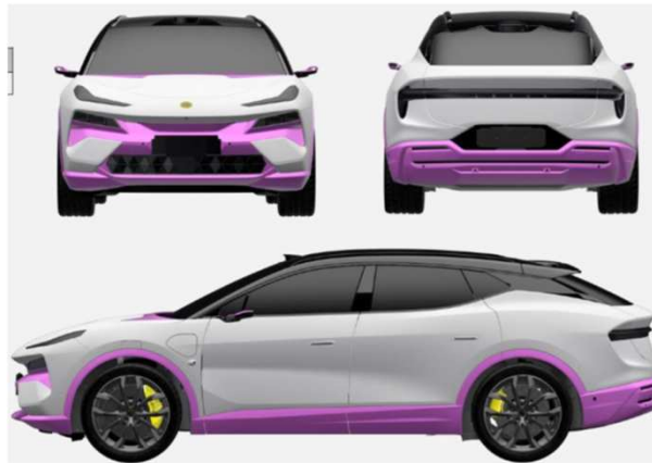
エクステンデッドカーボンパック (フロントリップスポイラー、ロアリアディフューザー、サイドミラーケース、ボンネットパネル、フロントバンパーミッド&ロアパネル、ホイールライナー、ドアパネル、リアバンパーパ)
