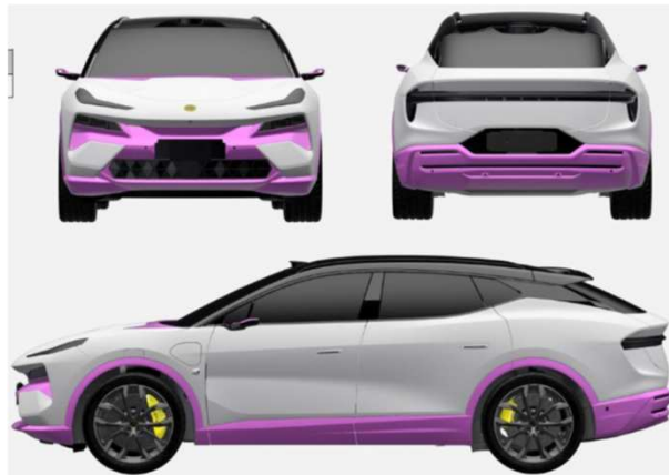
エクステンデッドカーボンパック (フロントリップスポイラー、ロアリアディフューザー、サイドミラーケース、ボンネットパネル、フロントバンパーミッド&ロアパネル、ホイールライナー、ドアパネル、リアバンパーバ)
